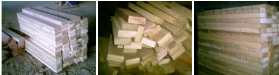
รูปที่ 3-12 ไม้ที่ผ่านกระบวนการไสเรียบสีหน้าแล้ว
