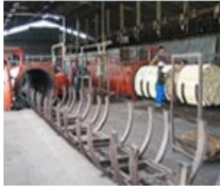
รูปที่ 3-9 การอัดน้ำยาไม้ยางพารา โดยวิธีสุญญากาศ
