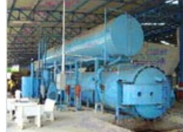
รูปที่ 3-9 การอัดน้ำยาไม้ยางพารา โดยวิธีสุญญากาศ
